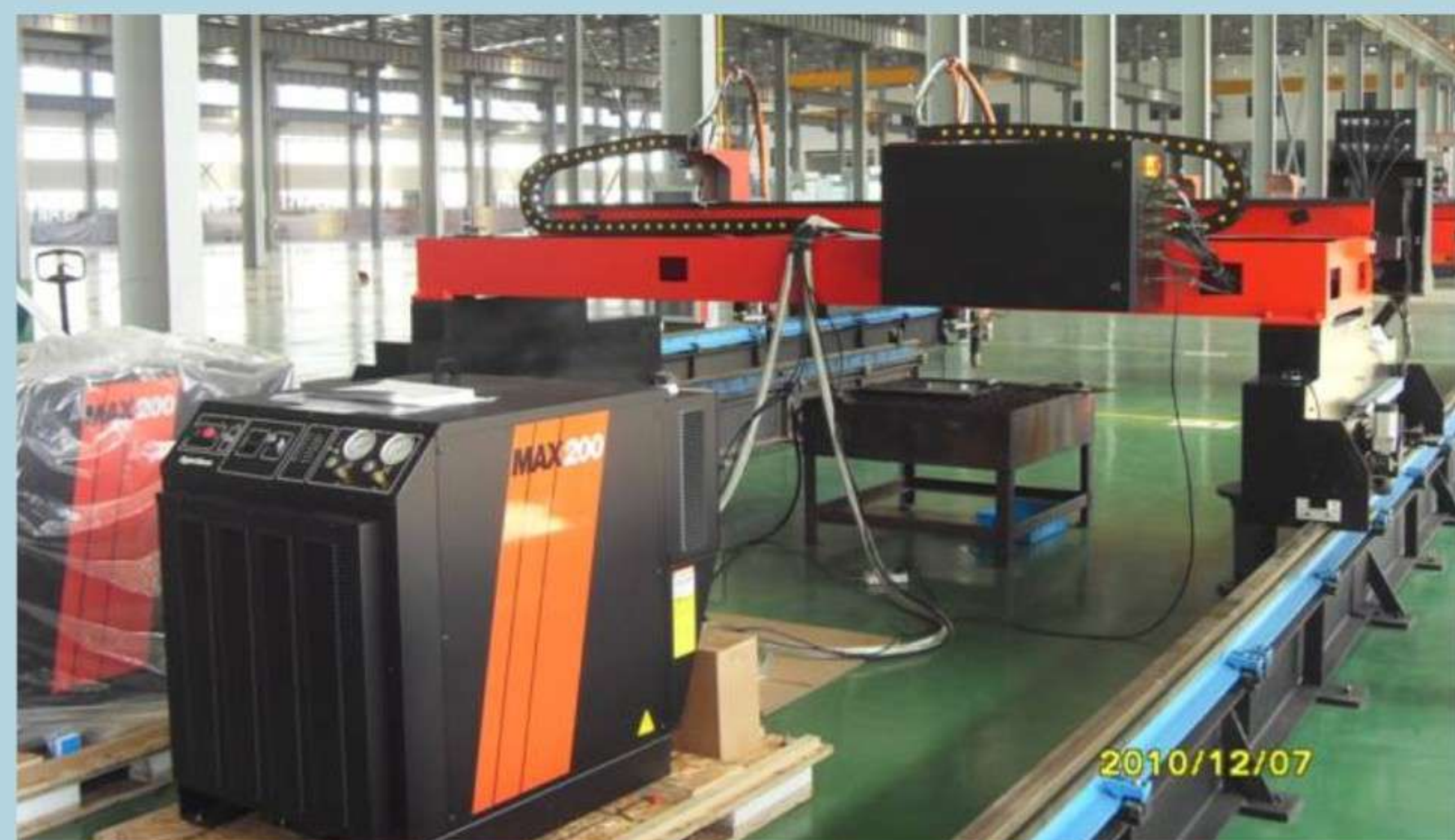
同时带2台海宝MAX200等离子电源无任何干扰
